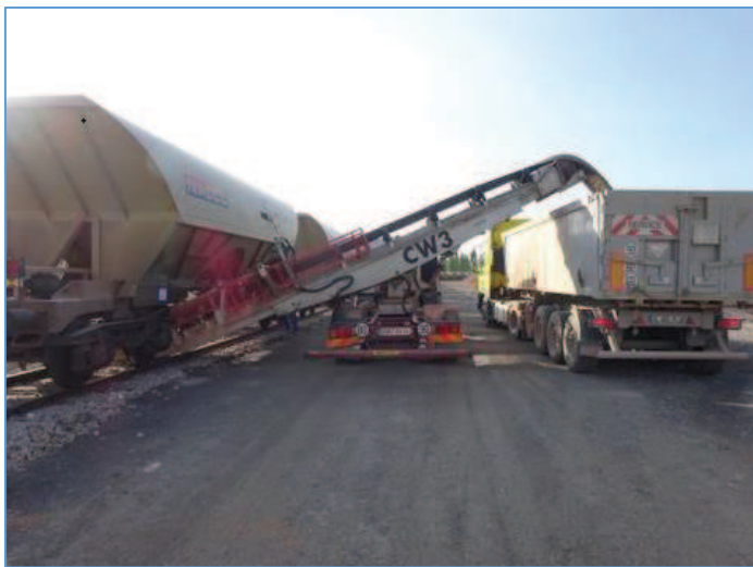
Fig. 23 : Exemple de déchargement de train (sauterelle et camion)
