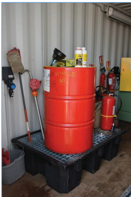
Fig. 38 : Stockage des huiles sur rétention
